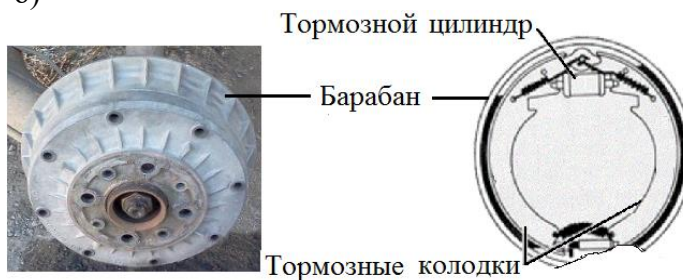
Рисунок 5 – Дисковый и барабанный тормозные механизмы
